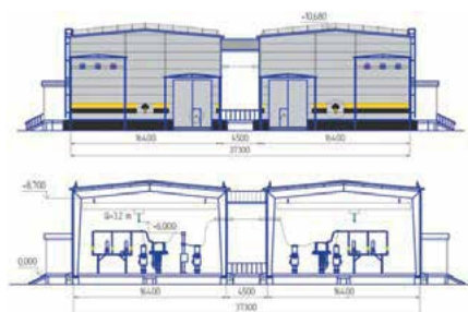
Закрытое распределительное устройство ЗРУ-СЭЩ 110 кВ
