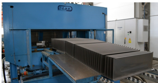
Производство корпусов трансформаторов
