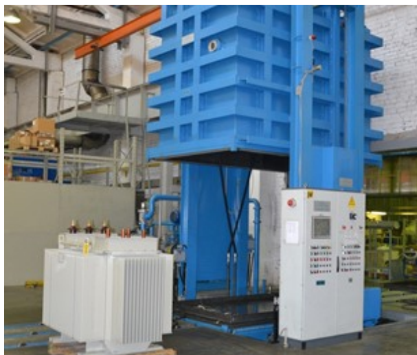
Заливка трансформаторного масла
