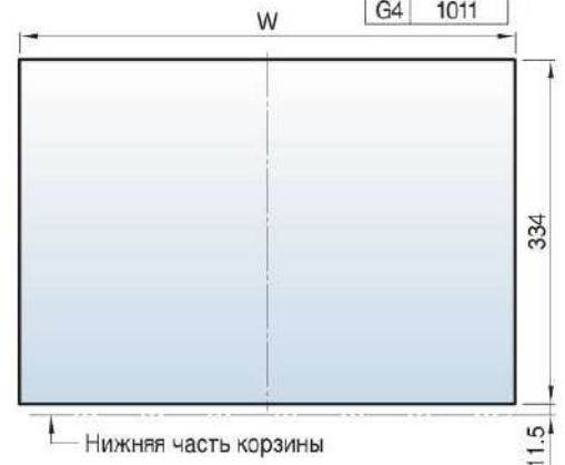
Рисунок В.33 – Габаритные размеры выреза в двери
