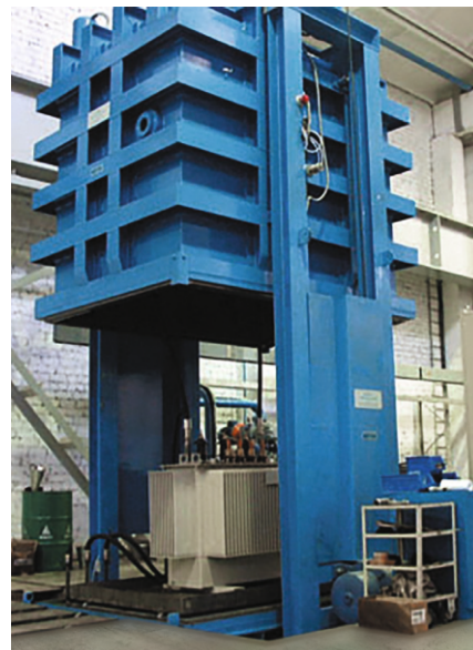
Участок заливки масла в ТМПНГ-СЭЩ
