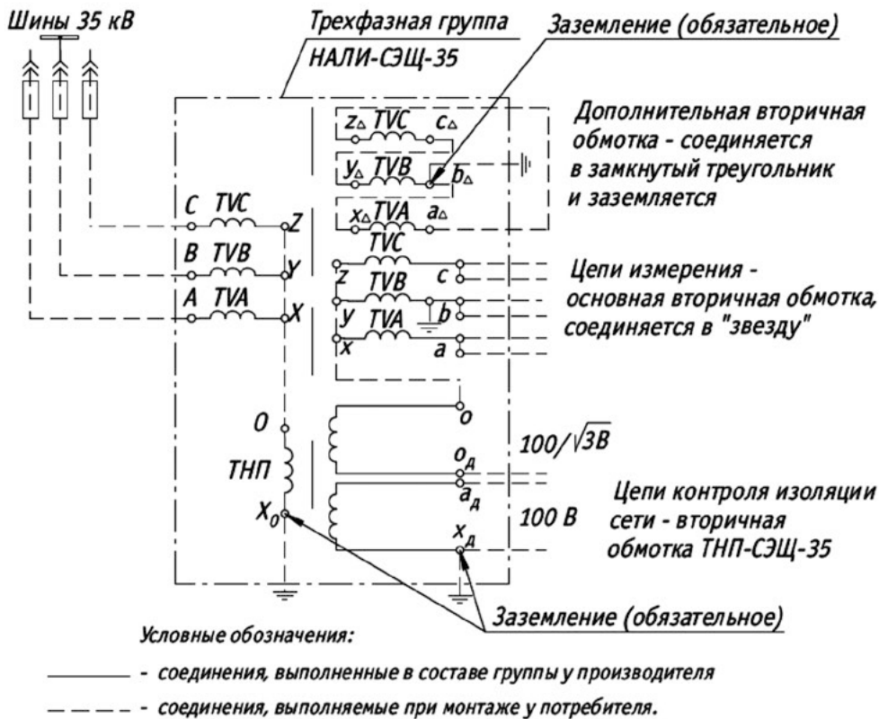
Принципиальная электрическая схема соединения обмоток трансформаторов напряжения трехфазной антирезонансной группы НАЛИ-СЭЩ-35 (с одной основной вторичной обмоткой)
