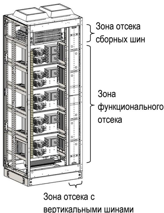
Рисунок 18 - Шкаф с устройствами компенсации реактивной мощности
