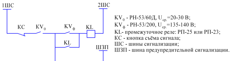
Рисунок 2 Автоматическая схема оперативных цепей защиты от феррорезонансных процессов
