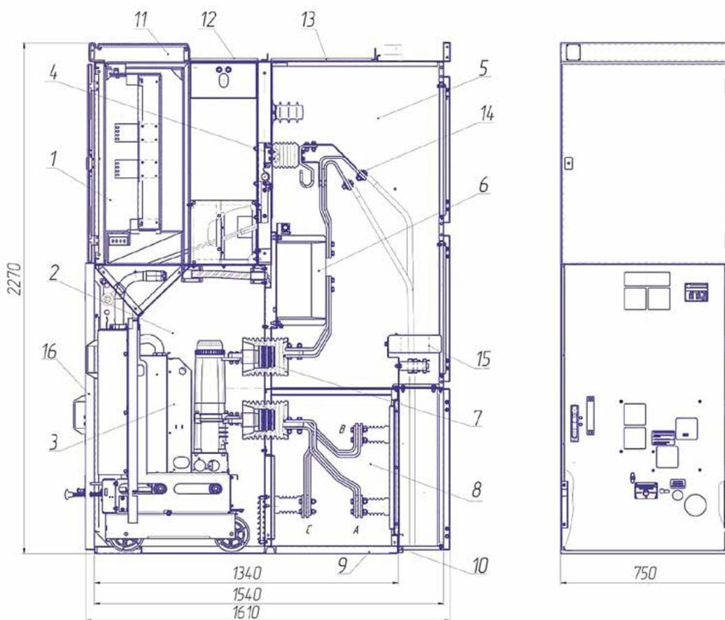
Рисунок 4. Шкаф кабельного ввода (вывода) с дверью отсека выкатного элемента
