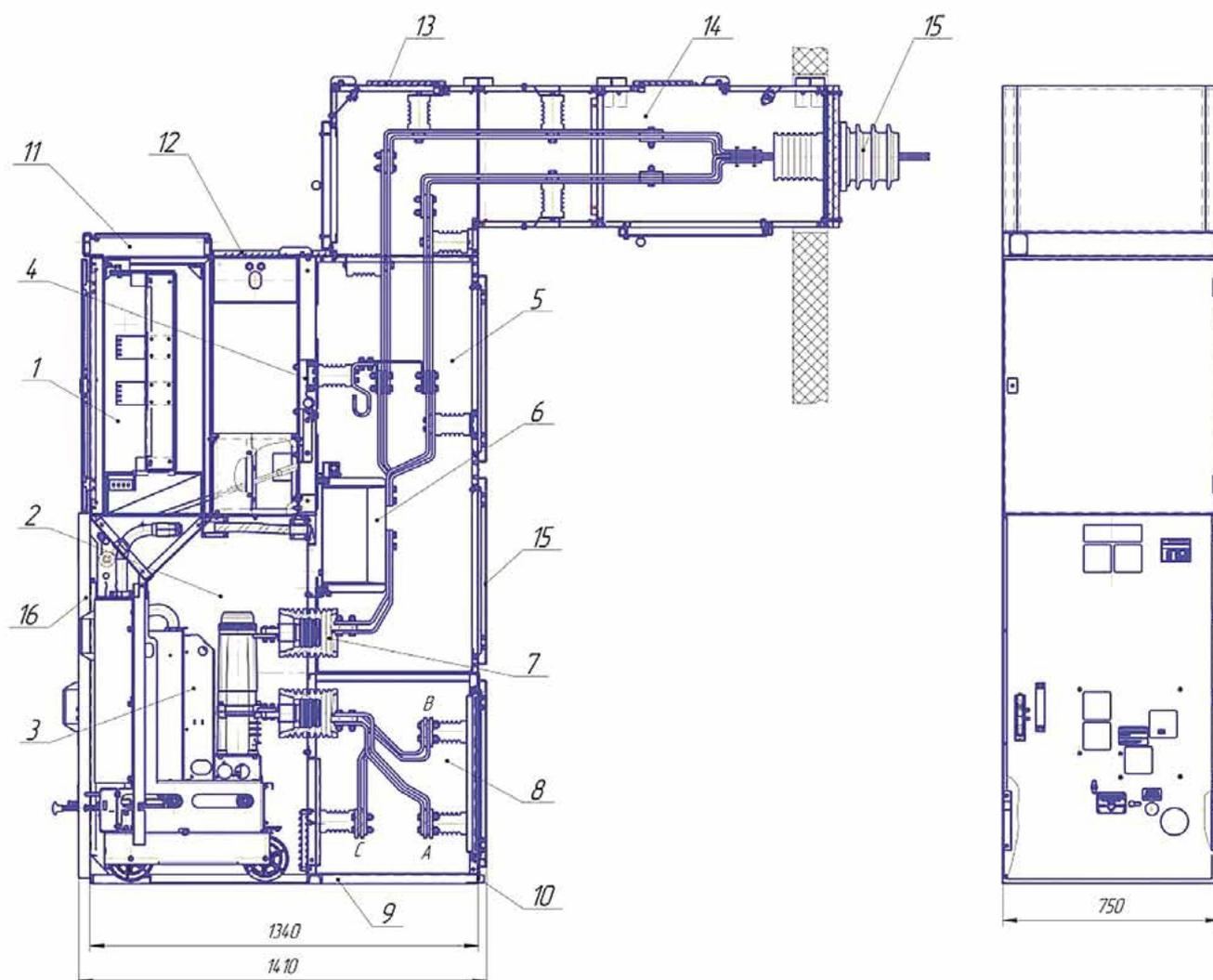
Рисунок 3. Шкаф шинного ввода (вывода) с дверью отсека выкатного элемента
