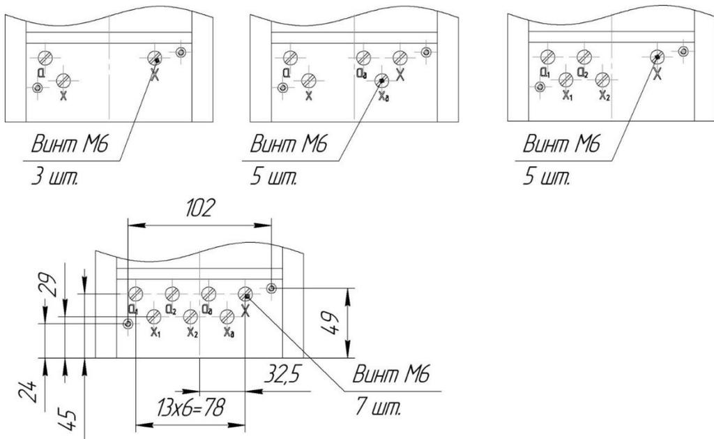
Рисунок 9 - Расположение вторичных выводов трансформаторов ЗНОЛ-СЭЩ-6(10)-
