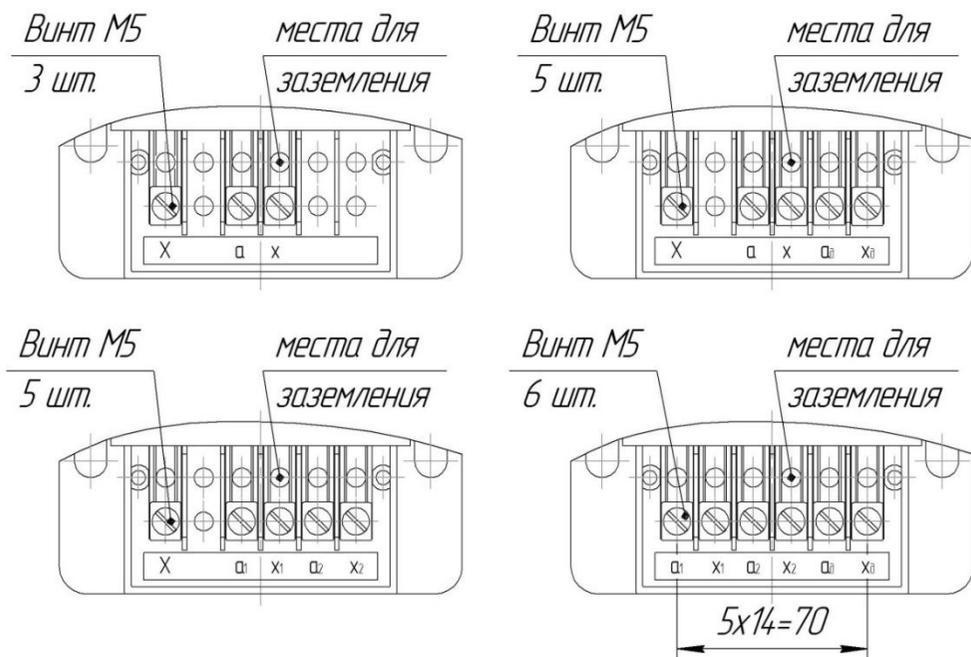
Рисунок 7 - Расположение вторичных выводов трансформаторов ЗНОЛ-СЭЦ-6(10)
