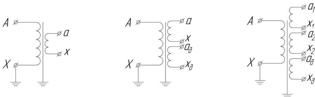
Рисунок 6 - Принципиальные электрические схемы трансформаторов ЗНОЛ-СЭЦ-6(10)-10
