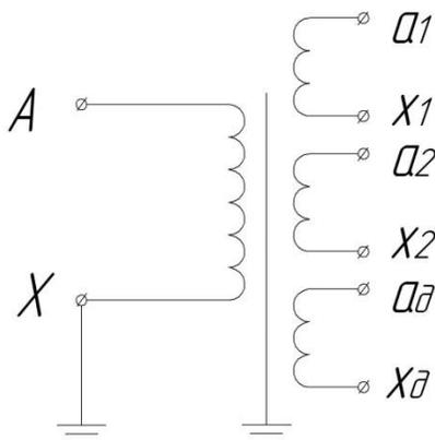
Рисунок 5 - Принципиальные электрические схемы трансформаторов ЗНОЛ-СЭЩ-6(10), ЗНОЛ-СЭЩ-6(10)-20
