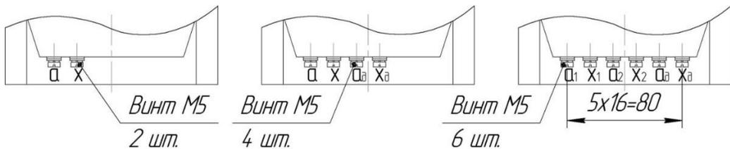
Рисунок 8 - Расположение вторичных выводов трансформаторов ЗНОЛ-СЭЩ-6(10)-
