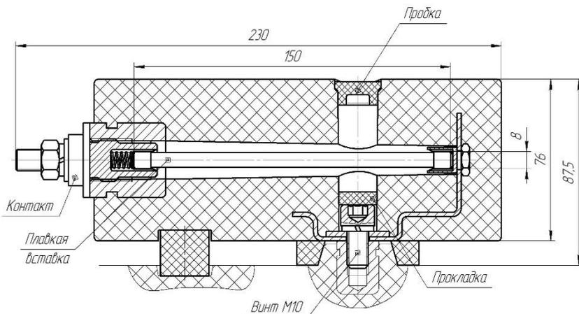
Рисунок 2 – Предохранительное устройство
