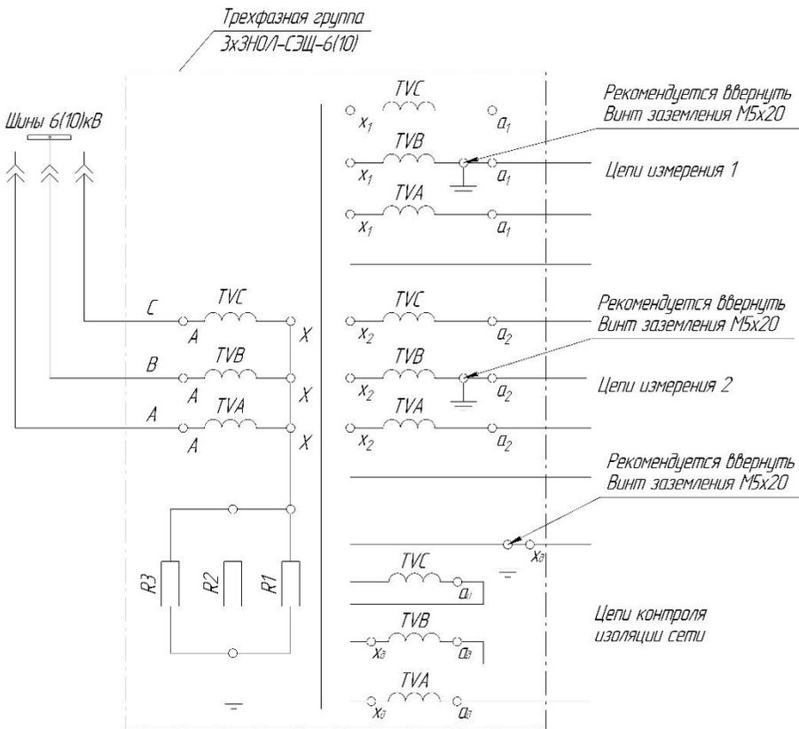
Рисунок 6 - Принципиальная электрическая схема соединения обмоток трехфазной группы измерительных трансформаторов ЗХЗНОЛ-СЭЩ-6(10)-21(22) с тремя вторичными обмотками.
