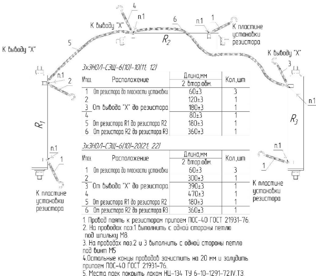
Рисунок 8 - Монтажная схема соединения резисторов
