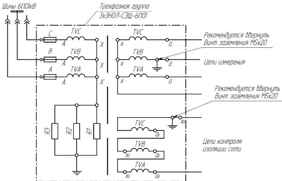
Рисунок 5 - Принципиальная электрическая схема соединения обмоток трехфазной группы измерительных трансформаторов ЗхЗНОЛ-СЭЩ-6(10)-21(22) с двумя вторичными обмотками
