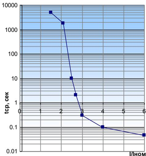
Рисунок 1 - Ампер-секундная характеристика плавких вставок предохранительного устройства
